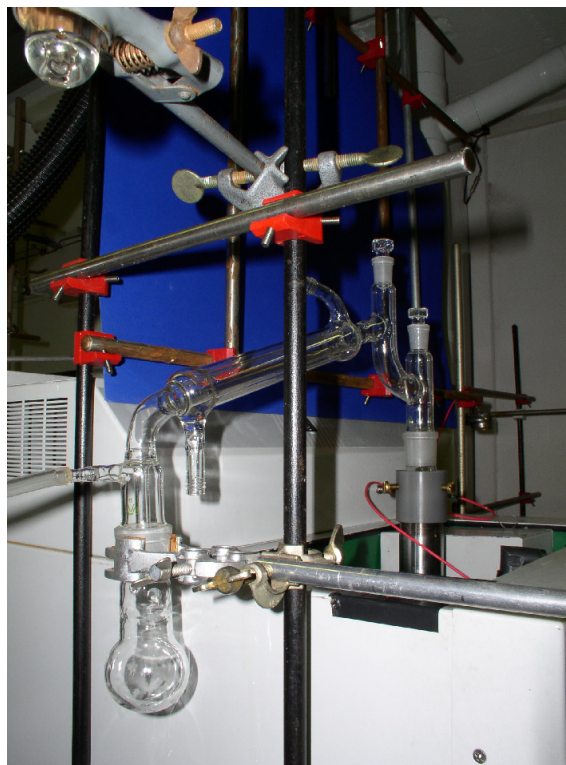
Bild 2: Destillationsbrücke als Aufbau auf dem Glasverbindungsrohr
