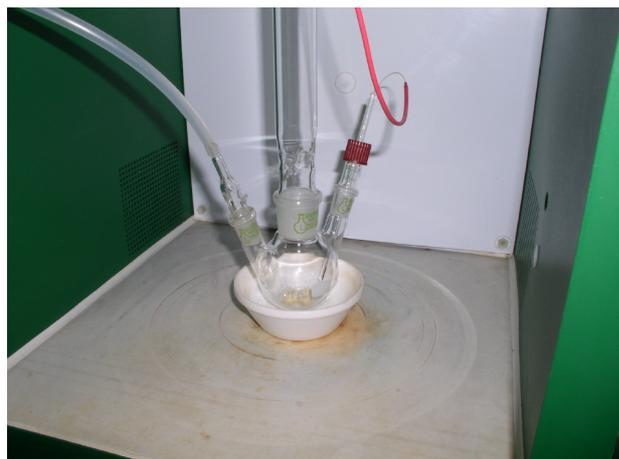
**Fotografía 2:** Puente de destilación como adición al tubo de conexión de vidrio
