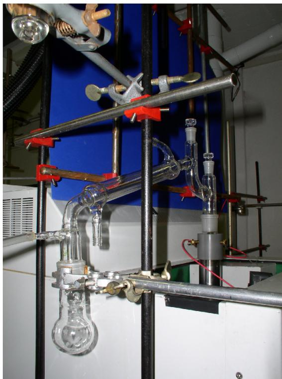
Se colocan 15,1 g (100 mmol) de 3-nitrobenzaldehido, 9,32 g (4,23 mL, 150 mmol) de etanodiol y 1,0 g (5,3 mmol) de ácido *p*-toluensulfónico monohidrato en un matraz de tres bocas de 100 mL equipado con barra de agitación magnética o un agitador de cruz. La mezcla
