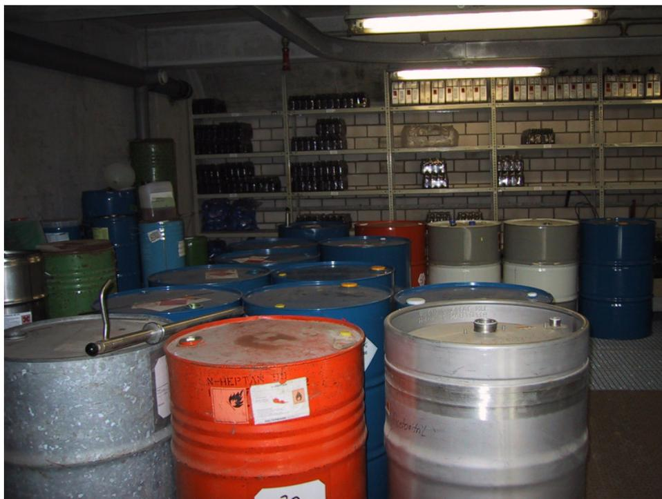
**Figura 1:** Fotografia di un deposito di stoccaggio. In primo piano è possibile osservare dei bidoni di solvente vuoti, che vengono separati dai rifiuti chimici immagazzinati (sullo sfondo).
