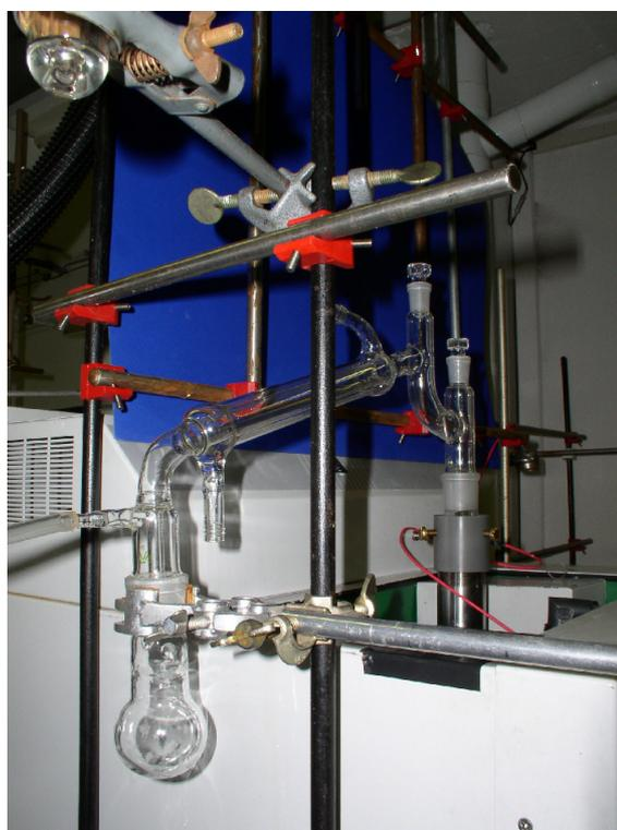
Dotare il recipiente di reazione di ancoretta magnetica (preferibilmente a croce) e aggiungervi 15,1 g (100 mmol) di 3-nitrobenzaldeide, 9,32 g (8,40 mL, 150 mmol) di etandiolo e 1,0 g (5,3 mmol) di acido 4-toluensolfonico monoidrato; mantenendo sotto costante agitazione,
