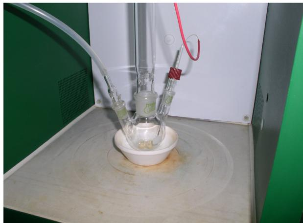
**Figura 2:** Apparato di distillazione montato sul tubo connettore di vetro.
